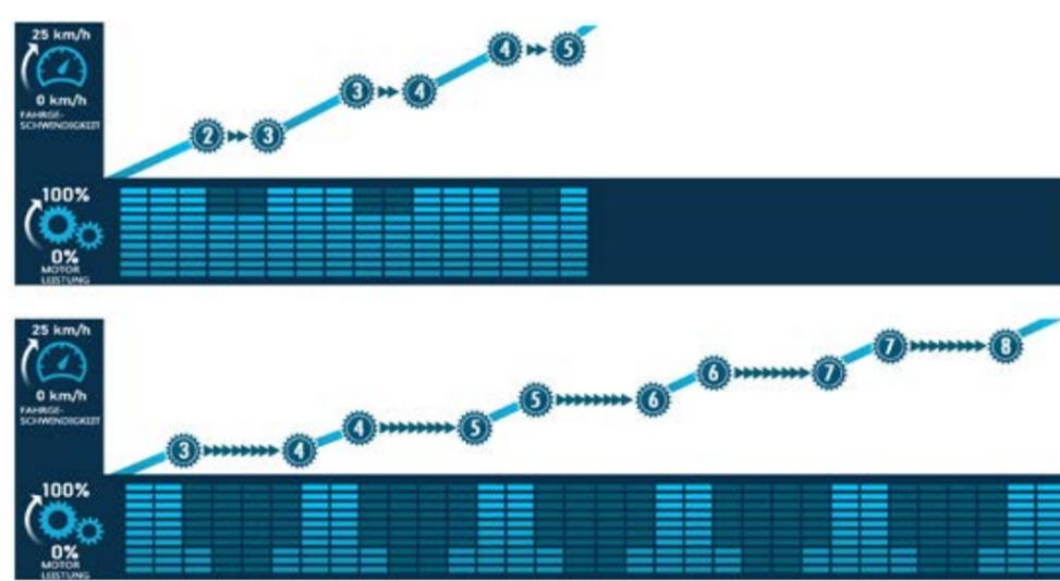
Herstellerangabe Shimano: Schaltvorgänge Nexus Inter 5E Di2 Getriebe (oben) im Vergleich mit Alfine Di2 8-Gang Getriebe (unten).
