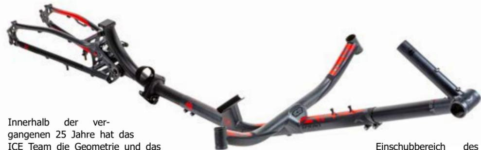
Innerhalb der vergangenen 25 Jahre hat das ICE Team die Geometrie und das Gewicht ihrer Rahmen immer weiter perfektioniert. Der ICE Hauptrahmen besteht aus hochwertiger 25CrMo4 Chrom-Molybdän Legierung, sowie einem Tretlagerausleger und einem Hinterbau aus 7005er Aluminium. Diese Kombination ermöglicht eine besonders schlanke und elegante Formgebung.
