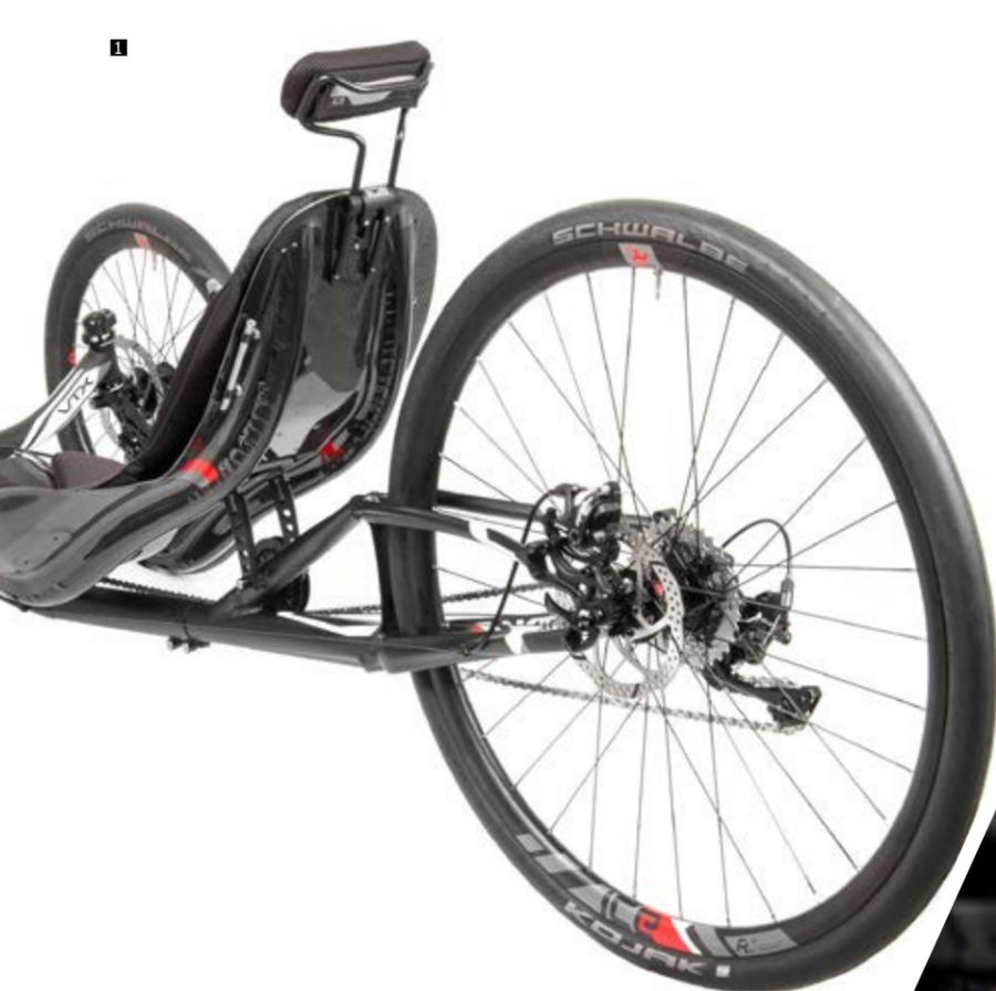
**1** Das Hinterrad kommt in der für Rennradfahrer vertrauten Laufradgröße 622. Das sorgt für Laufruhe, bügelt kleinere Unebenheiten aus und bietet die bekannten Entfaltungen eines herkömmlichen Rades.
