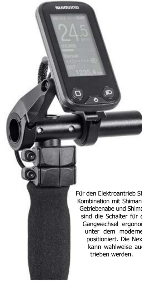
Für den Elektroantrieb Shimano Steps EP8 in Kombination mit Shimano Nexus Inter 5E Di2 Getriebenabe und Shimano Deore XT 1x11 Di2 sind die Schalter für den Elektroantrieb und Gangwechsel ergonomisch vorteilhaft direkt unter dem modernen großflächigen Display positioniert. Die Nexus Inter 5 E Getriebenabe kann wahlweise auch im Automatikmodus betrieben werden.
