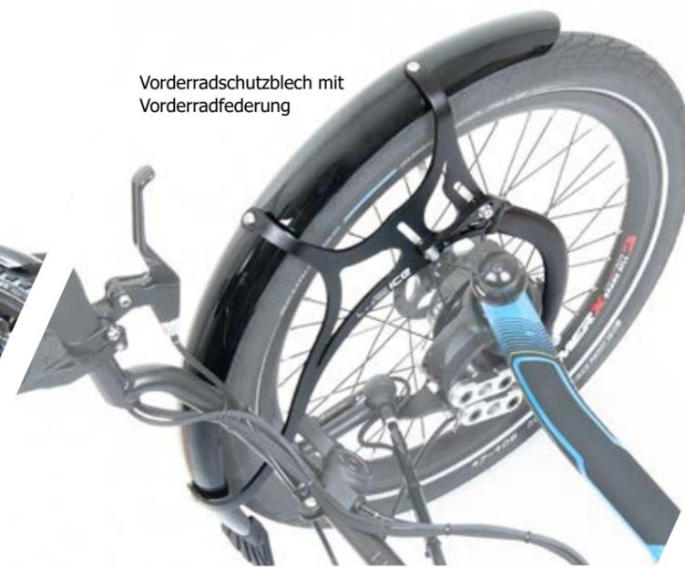
Vorderradschutzblech mit Vorderradfederung
