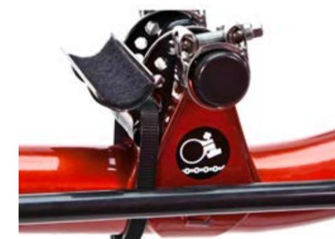
Mit dem Front Forward (FF) und Front Backward (FB) Adapter kann der Sitz 5 cm nach vorn oder nach hinten versetzt werden, um das Liegedreirad noch besser an die Körpergröße des Fahrers anpassen zu können.
